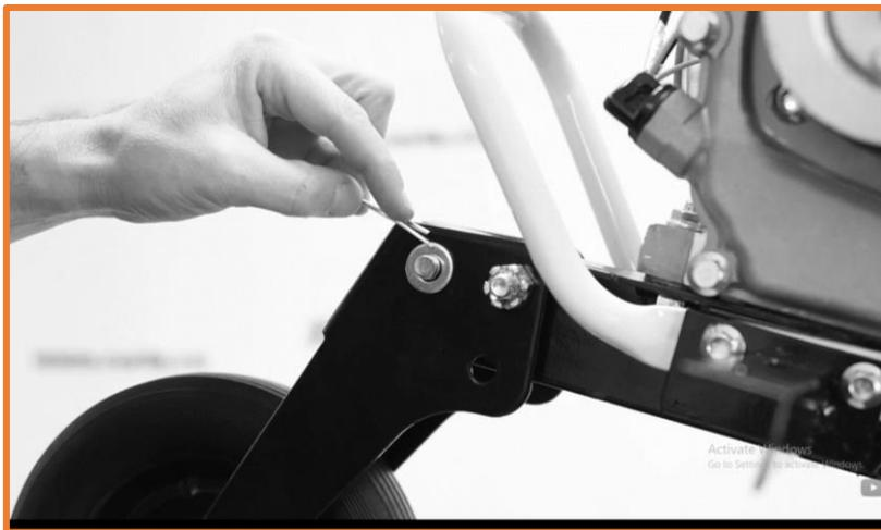
Montați coarneaule și fixați-le cu maneta de strângere mâner. ( în funcție de modelul de coarne)
