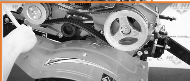
Schimbatorul de viteze se montează și se blochează cu ajutorul bolțului – siguranței.
