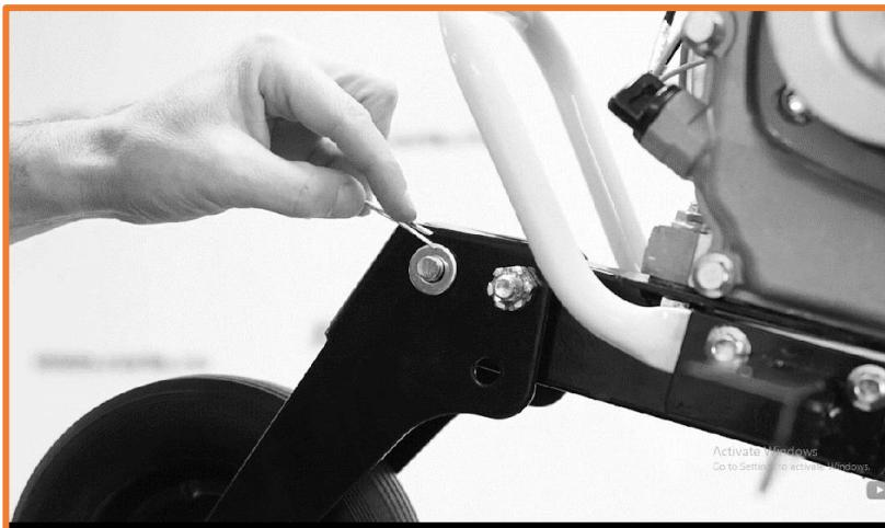
Montați coarnele și fixați-le cu maneta de strângere mâner (în funcție de modelul de coarne).
