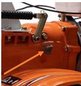
Fig. 5 – Verificarea nivelului de ulei al transmisiei
