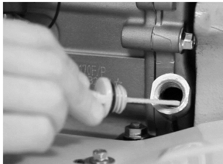
Fig. 5 – Verificarea nivelului de ulei transmisie
