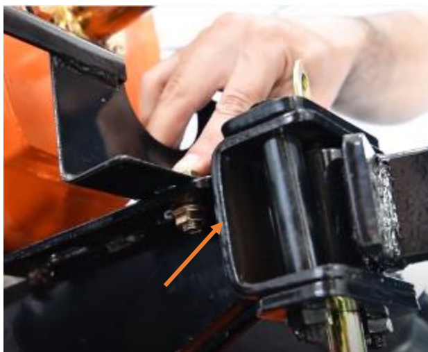
Монтира се на задњи носач крила.
