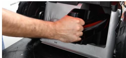
3. Τοποθετήστε το σχοινί εκκίνησης στο άγκιστρο στήριξης.
