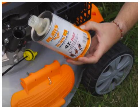
Pojemność kąpieli olejowej silnika 0,55l
