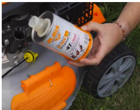
Capacità bagno olio motore 0,55 l
