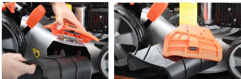
2. Zakryte vyhadzovací otvor krytom, aby sa aktivovala funkcia mulčovania a bočného vyhadzovania.
