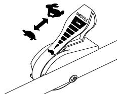
**Attention :** Pour arrêter le moteur procéder comme suit : l'accélération du moteur est réduite au minimum, après quoi la poignée d'arrêt est relâchée. Ne pas s'arrêter avec la poignée d'arrêt d'urgence lorsque le moteur tourne au régime maximum sauf en cas d'urgence.
