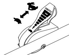
**Pažnja :** Za zaustavljanje motora postupite na sljedeći način: ubrzanje motora se smanji na minimum, nakon čega se otpusti ručica za zaustavljanje. Nemojte se zaustavljati s ručkom za hitno zaustavljanje kada je motor na najvećoj brzini, osim u slučaju nužde
