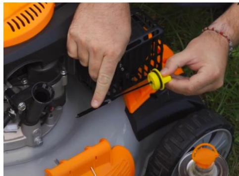
Schimbați uleiul de motor după primele 5 de ore de funcționare, aceasta fiind perioada de rodaj, apoi la fiecare 25 ore de funcționare sau la 6 luni.
