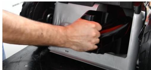
3. Placez la corde de démarrage sur le crochet de support.
