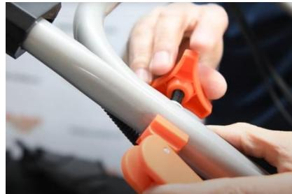
3. Upevnite káble pomocou svoriek .
