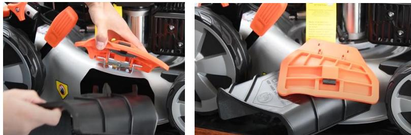
2. Verschließen Sie die Auswurföffnung mit einer Abdeckung, um die Mulch- und Seitenauswurffunktion zu aktivieren.
