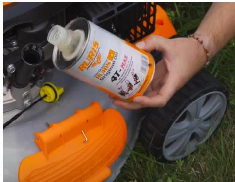
Kapacitet kupelji motornog ulja 0,55l
